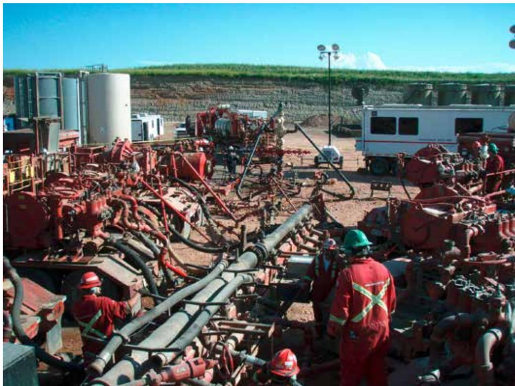
Um Schiefergas durch Fracking (Frack = Riss) zu fördern, wird zuerst eine Bohrung senkrecht niedergelassen, dann wird der Bohrkopf mehrere Kilometer unter der Erdoberfläche seitlich abgelenkt und horizontal durch das Gestein geführt. Danach werden Wasser, Sand und eine Reihe von Chemikalien unter hohem Druck in das Gestein gepresst (Bild). Die Mischung reisst
